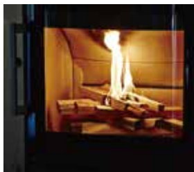
焚き付けを上置き、天辺から着火することで、煙突からの排煙を最大限抑えられる。また、薪の太さや乾燥具合も重要！
