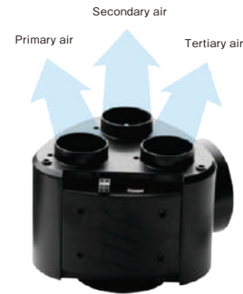
【エアボックス】 センサーから送られてきた酸素濃度、温度から一次、二次、三次各空気孔への吸気量を自動で算出。
